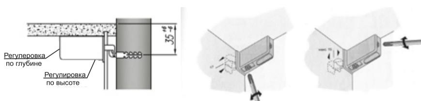
Прикрепите к стене несущие пластины или крючки в соответствии со схемой
