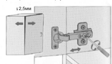
Освободить крепежный винт и отрегулировать расстояние между дверью и боковой шкафом. Затем крепежный винт снова затянуть.
