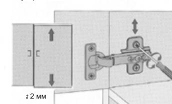
При помощи ответных планок регулируемых по высоте, можно точно установить высоту положение двери.
